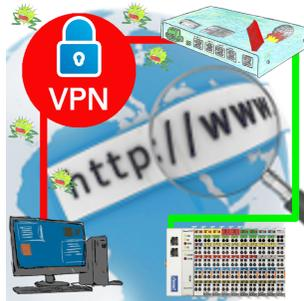
Fernwartung einer Beckhoff-Steuerung mit Netzwerk-Anschluss über gesicherten VPN-Tunnel und skalierbarer Firewall
