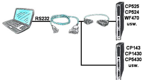
Sie haben einen PC mit Programmiersoftware und als Schnittstelle steht Ihnen der 9polige COM-Port zur Verfügung? Kein Problem, das PG-UNI-II-Kabel ist hier genau das richtige Produkt. An Siemensbaugruppe wie H1-CP (CP1430), WF470 und PC oder CP-525 mit CP525-Adapter und PC angesteckt und Sie sind Online.
