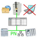
S7-SPS getriggerte DB-Sicherung/-Wiederherstellung ohne zusätzlichen PC über PN-Port auf FTP-Server
