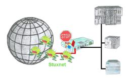
Schutz Ihrer Anlagen vor Viren-Angriffen wie zum Beispiel "Stuxnet" S7-Firewall oder TeleRouter mit S7-Firewall-Option zwischen SPS(en)/Maschinennetz und Betriebsnetz schalten, schon verhindern Sie eine Zerstörung Ihrer Anlagen- und Prozess-Daten.
