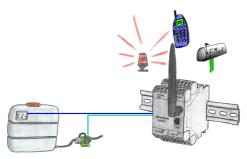
Mit EtherSens-Control-Geräten kleine Steuerungsaufgaben Ihrer Anlagen übernehmen. Legen Sie Schaltpunkte fest, an denen das Gerät Aktionen ausführt, reagieren muss. Je nach Parametrierung eine EMail- oder SMS-Benachrichtigung (abhängig der Geräte-Konfiguration) oder das Gerät steuert selbstständig über die optionalen IO-Module (Analog/Digital/Relais).
