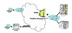
Der Zugriff auf die angeschlossene SPS-Steuerung erfolgt mittels einer Kopplung über Analog-, ISDN- (mit AB-Adapter), sowie über GSM-Strecke (mit ext. GSM-Modem).
