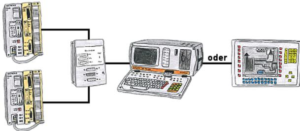
Sie müssen mit mehreren SPS-Steuerungen arbeiten, haben aber keine Lust sich dauernd ab- und anzustecken? Kein Problem, Sie schließen ein Gerät der AG-Switch-Serie an den SPS-Steuerungen sowie Ihren PC/PC an und schon können Sie mit den Steuerungen kommunizieren. Die Auswahl des entsprechenden Teilnehmers führen Sie beim AG-Switch-I mittels Kippschalter und beim AG-Switch-II per 24V-Steureingang durch.
