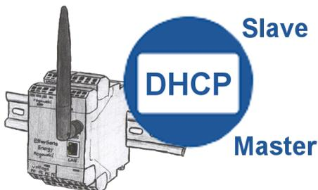
Sie benötigen einen DHCP-Server in Ihrem Netzwerk. Aktivieren Sie diese Funktionalität in Ihrem EtherSens-Gerät und Sie haben sofort einen Server im Netz. Gleichbleibend kann das EtherSens-Gerät auch als DHCP-Slave agieren.
