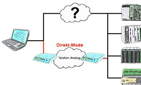
Sie haben in Ihrer Anlage eine Steuerung, Datenlogger oder Umrichter integriert, deren Protokoll nicht unterstützt wird. Kein Problem, über den Direktmode werden die Zeichen, die der PC im Büro sendet über die Telefonleitung übertragen und vor Ort vom TP/TB wiedergegeben. Der Rückweg ist identisch. So steht Ihnen in diesem Fall ebenfalls eine Kommunikation zu diesen Baugruppen über die Fernwartung zur Verfügung.
