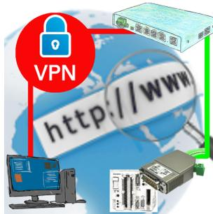
Fernwartung einer Siemens-S5-Steuerung mit S5-LAN++ an PG-Schnittstelle über gesicherten VPN-Tunnel des TeleRouter
